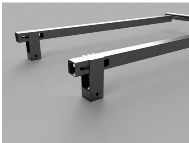
Figur 5.14: Her vises et af de mindre gelænder-elementer. På billedet er det monteret på de tilhørende fødder, som via en specialkonstrueret stiftslidssamling tillader den nødvendige mekaniske bevægelighed, som giver mulighed for lodret eller vandret fiksering samt bevægelse under ned- og opklapning
