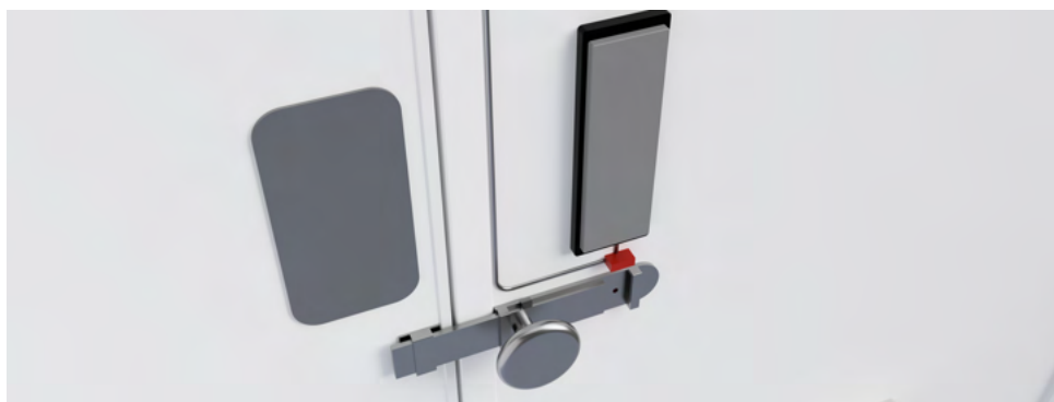
Figur 5.15: Rendering af den indre manuelle betjening. Her ses hvorledes albueknop, skydelås, trykplade og reed-kontakt tænkes placeret i forhold til hinanden. Særligt er magneten - den lille øverste del på skydelåsens glider - interessant. Magneten frakobler via reed-kontakt albueknappen når låsen er skudt for.
