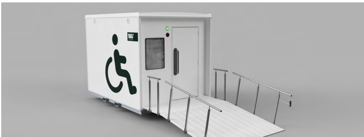
Figur 5.8: Rending af det endelige koncept for toiletvognen set udefra. Her ses flere elementer som gennemgås i afsnittet: Synlighedsfremmende ikoner, foldbare gelænder, NFC-kortlæser på gelænder, infotavle, nyt dørgreb, ny ledig/optaget-indikator.
